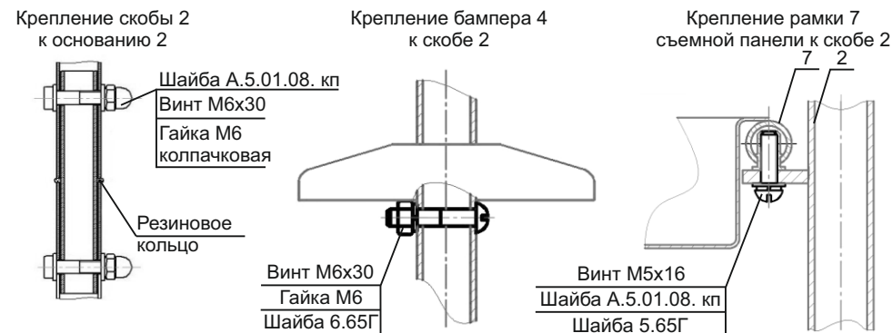
1 - основание; 2 - скоба; 3 - съемная панель; 4 - бампер; 5 - колесо без тормоза; 6 - колесо с тормозом; 7 - рамка; 8 - педаль тормоза.
